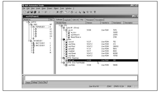
Figure 46: Open initial parameter module AX1\_PAR
